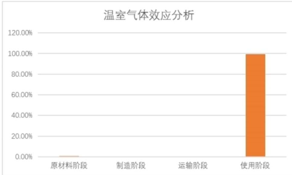
可见，使用阶段的温室气体排放最多，占比达到 99.25%，原材料阶段次之，占比 0.70%。故，在能够满足产品性能要求的同时，企业应提高对自身的要求以提高产品的竞争力，重点攻关以下关键技术降低使用阶段和原材料阶段的温室气体排放。
